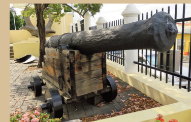
Dit gietijzeren kanon is geconserveerd met de elektrolytische behandeling
