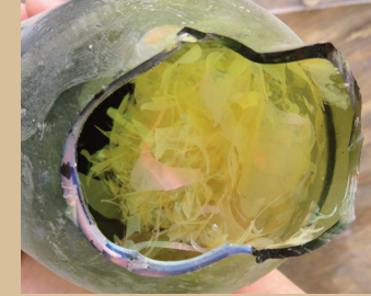
Deze oude fles schilfert kapot door het zout in het glas
