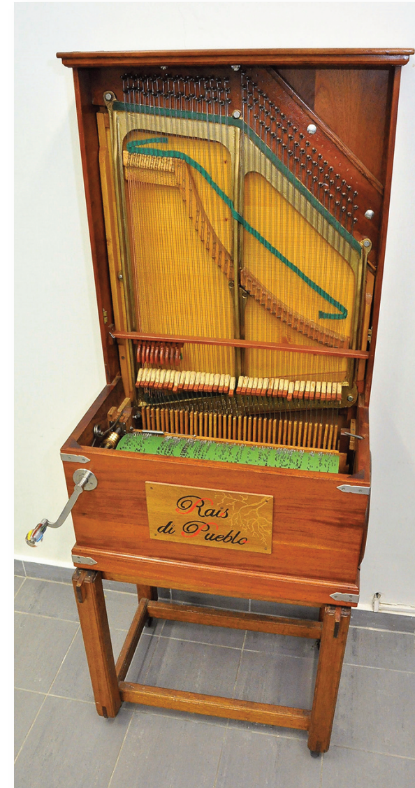
Ka'i òrgel met de zwengel, cilinder met spijkertjes en de snaren zichtbaar
